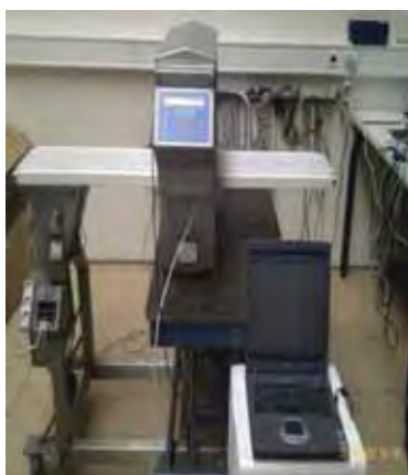
1a. System detekcji metali detectronic użyty w testach materiałów wykrywalnych przez detektory metali.
